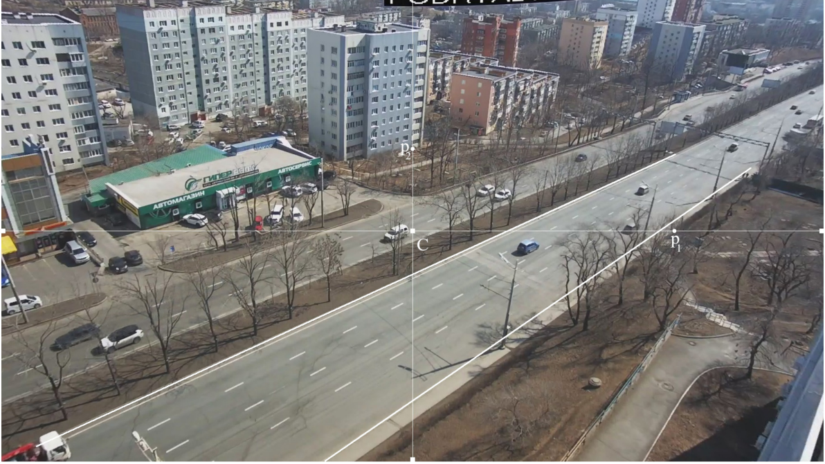
Рис. 4. Изображение с камеры после компенсации радиального искажения.
