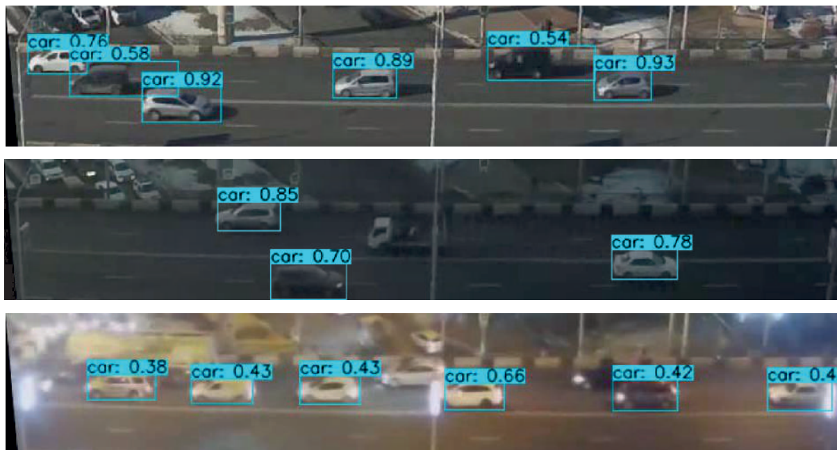
Рис. 4. Результаты работы сети YOLOv4 на изображениях наблюдаемой зоны движения в различных условиях
