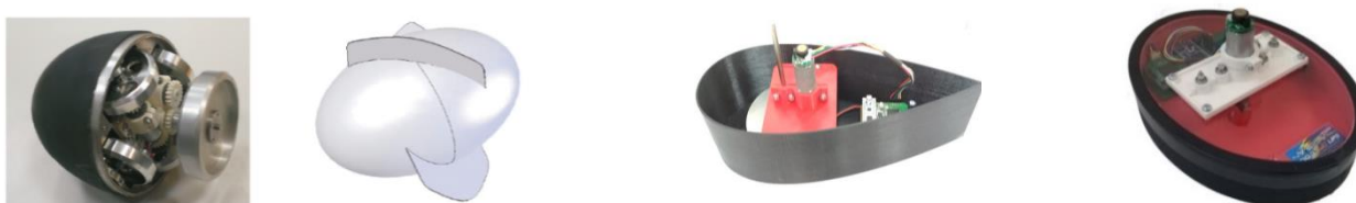
Рис. 2 – Прототипы безвинтовых подводных и надводных роботов
