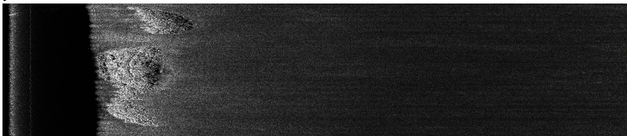
Рисунок 1 — Восстановленный профиль морского дна при нахождении коэффициента донного отражения в каждой точке
